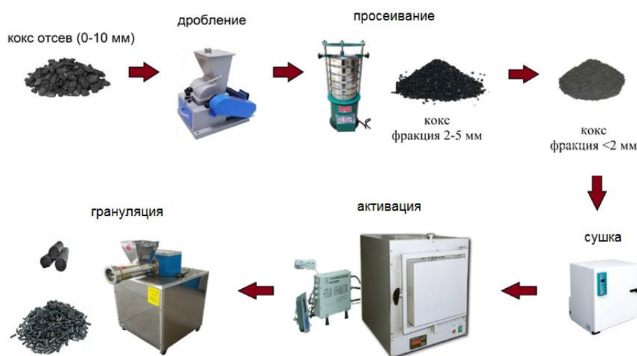
Рисунок 1 – Схема получения углеродного сорбента
