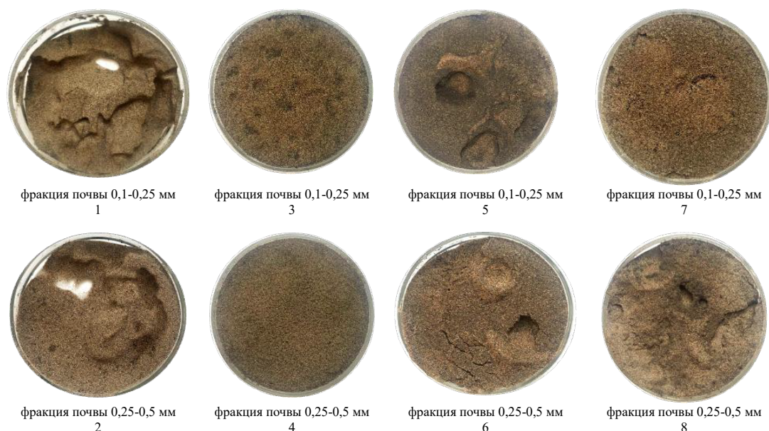
Рисунок 16 – Поверхность почвенных образцов после проведения эксперимента по водной эрозии (1, 2 – контрольные образцы; 3, 4 – образцы, обработанные хитозаном; 5, 6 – образцы, обработанные ПАК; 7, 8 – образцы, обработанные ИПЭК)
